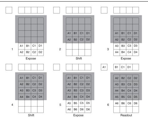
Figure 19. Kinetics Readout
